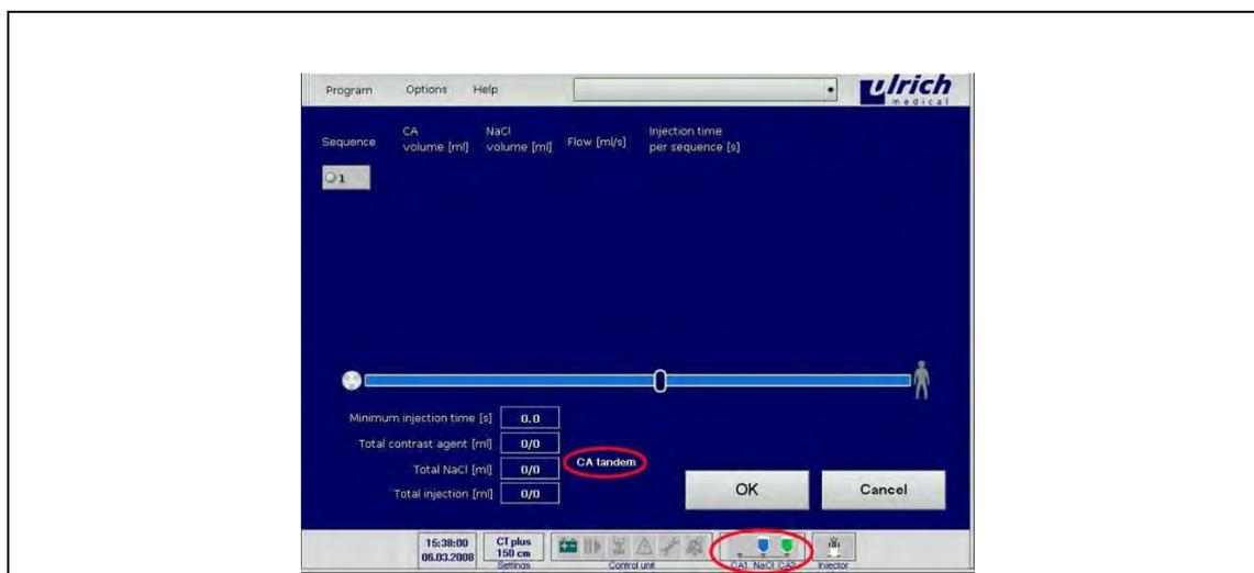
Рис. 83: Функция "КВ-тандем" активирована
