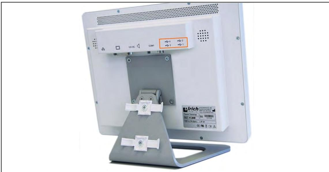
Рис. 113:Порты USB на сенсорном терминале
